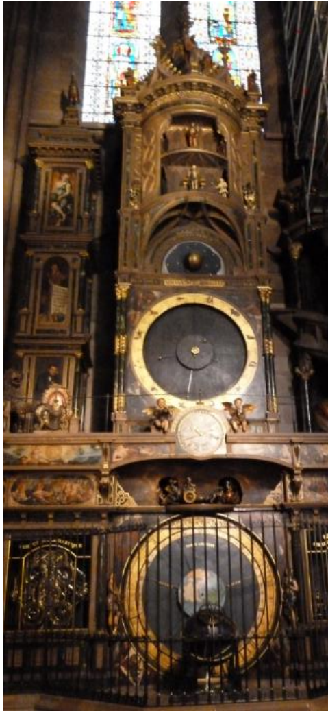
Cadran du temps apparent, avec plusieurs aiguilles (solaire, lunaire, heure du lever du soleil, heure du coucher du soleil), avec le globe terrestre.
