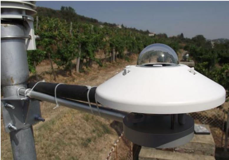
Certains **pyranomètres** mesurent les radiations solaires indirectes, qui traversent les nuages. Une bande fait de l'ombre pour protéger le pyranomètre des ondes directes du soleil
